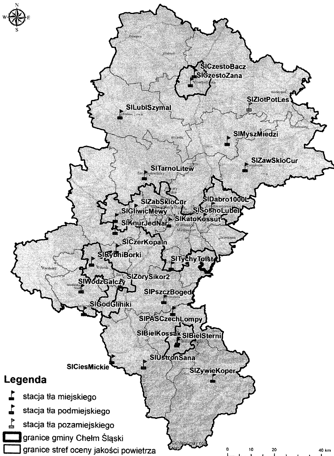
Rysunek 3. Lokalizacja stacji monitoringu realizowanego przez WIOŚ w Katowicach w 2015 roku na terenie strefy śląskiej – pomiary stężeń pyłu PM 10 , PM 2,5 , benzo(a)pirenu oraz ozonu. 51
